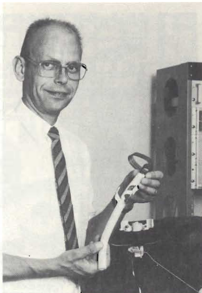
Nuovo sensore elettrotermico adottabile in produzioni su vasta scala e montabile anche in serbatoi di forma irregolare e con svariati tipi di carburante.
