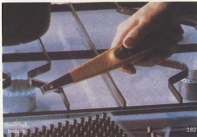
Fig. 7 - Accendigas piezoelettrico. In primo piano, alcuni elementi piezoelettrici utilizzati per la sua realizzazione.
