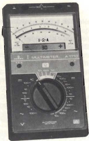
Multimetro A 1710 della Norma; commuta automaticamente dalla scala da 100 a quella con 30 divisioni quando la deflessione dell'ago rimane sotto il 30%.
