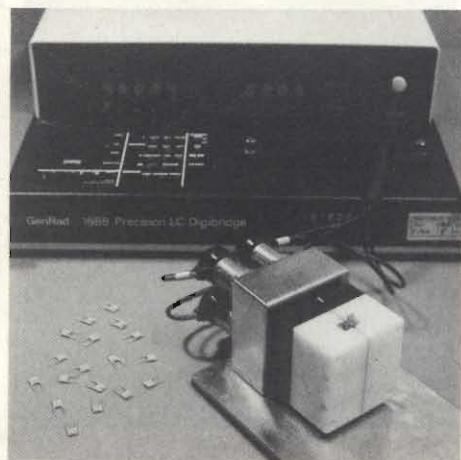
Controllo delle caratteristiche elettriche (valore della capacità, tg \delta e resistenza di isolamento) effettuato dal Reparto Controllo di qualità.
