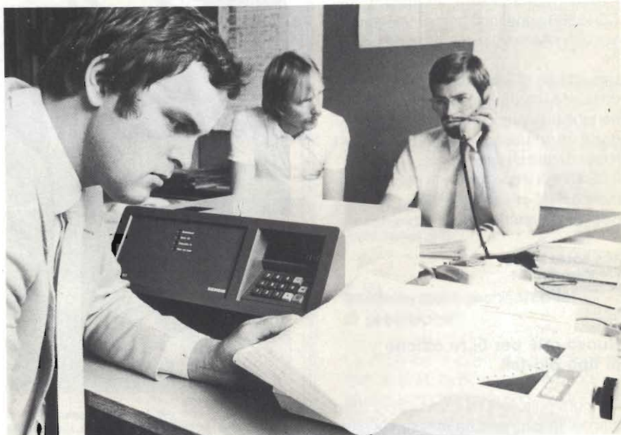
Il sistema elettronico di controllo degli accessi SM 801, realizzato dalla Siemens, permetteva finora di controllare l'accesso di 1300 persone in 4 diverse zone; la nuova esecuzione potenziata SM 802 consente di controllarne 2800 in 7 zone. Tutti gli eventi che si verificano nel sistema vengono registrati da una stampante collegata alla centrale.
