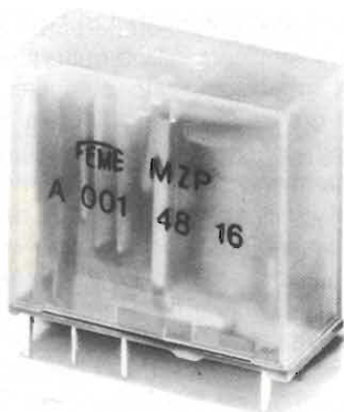
Relé da 16 A con un contatto di scambio o 1 NA o 1 NC, con doppia piedinatura in uscita o reticolo standard 2,5 mm.
